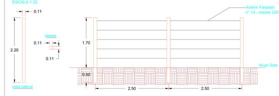
**DETALHES FIXAÇÃO DO ARAME NOS MURÕES**
