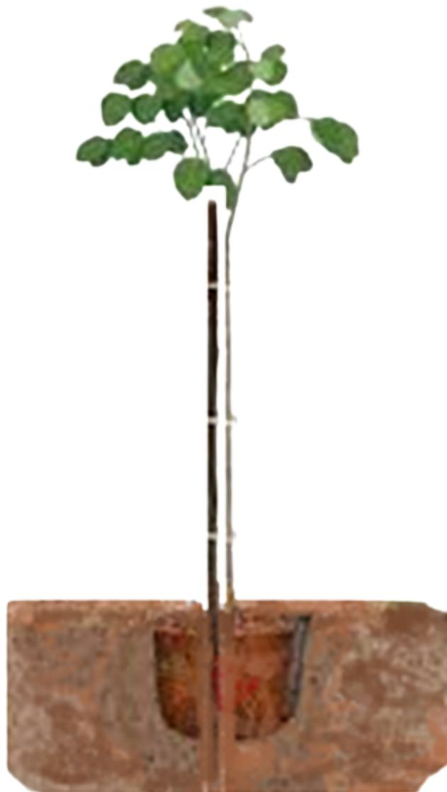
**Figura 27** - Detalhe da fixação de tutor junto a muda plantada.
