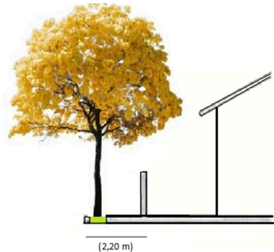
**Figura 03** - Detalhe da largura mínima da calçada em relação ao imóvel com recuo.
