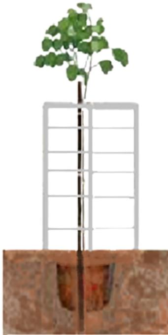
**Figura 28** - Detalhe da fixação de tutor e grade protetora (gradil) junto a muda plantada.
