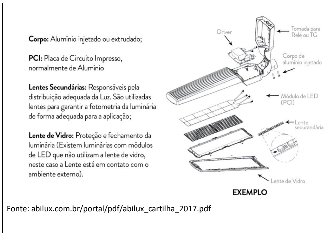
Figura 4 – Estrutura de Luminária LED
