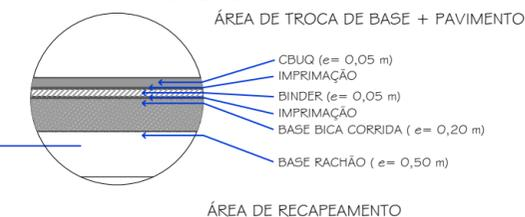
**SEÇÃO TÍPICA DO PAVIMENTO**
